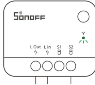
⚠ 当设备处于配网状态时，设备保持关闭状态，不受设备按键或外接开关的控制
