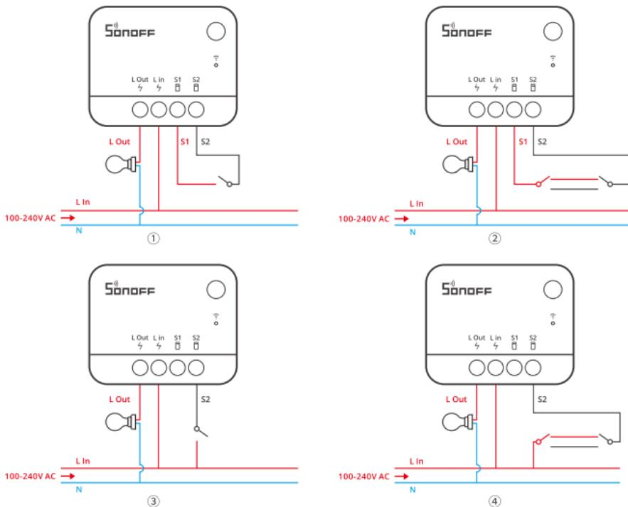
⚠ 以上③④接线方式请确保设备 L in 端供电输入正常，否则会导致设备工作异常。
